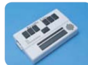
BRAILLE LITE Dispositivo de almacenamiento con teclado Braille, que se puede acoplar a un ordenador y a salidas varias
