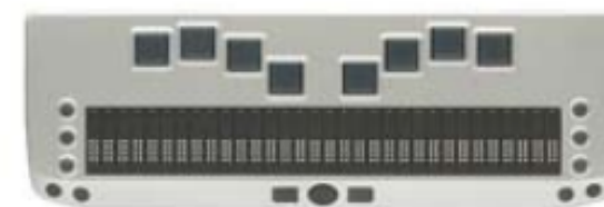
PERIFÉRICO CON TECLADO PARA ESCRIBIR EN BRAILLE Y LÍNEA BRAILLE PARA LEER EL MENSAJE
