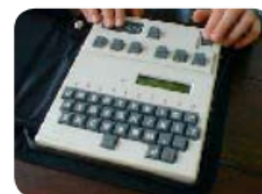
SCREEN BRAILLE COMUNICATOR Aparato que transcribe, en tiempo real, un mensaje escrito con teclado normal, al Braille y viceversa
